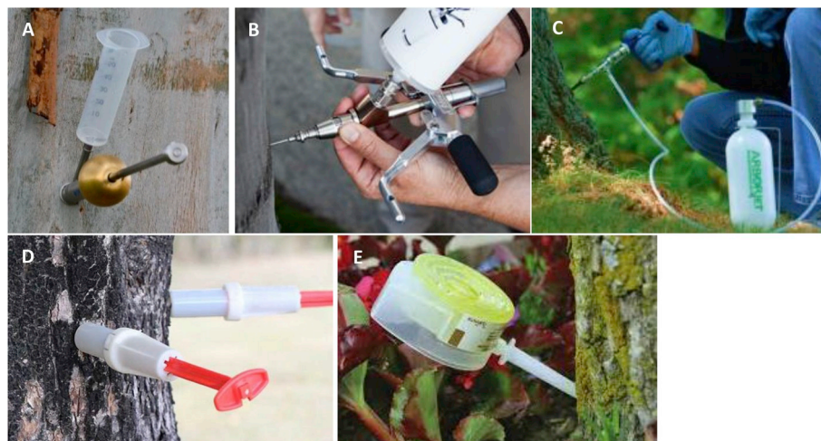
Fig. 1. Existing trunk-injection devices. (A) Bite ® , (B) Wedgle ® Direct-Inject System, (C) Quick-jet ® microinjection system, (D) ChemJet ® Tree Injector, (E) Maugey ® .
